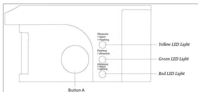
c) Taste A kurz betätigen, um die erste Betriebsart des Geräts einzustellen (jede weitere kurze Betätigung der Taste erlaubt das Umschalten zwischen den weiteren Betriebsarten)
