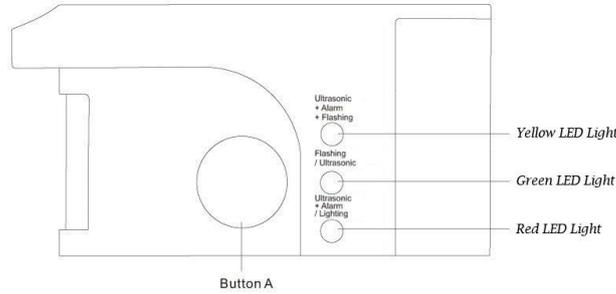
c) İlk çalışma modunu seçmek için A düğmesine kısaca basınız (düğmeye tekrar kısaca basılması halinde bir sonraki çalışma modu seçilmiş oluyor).
